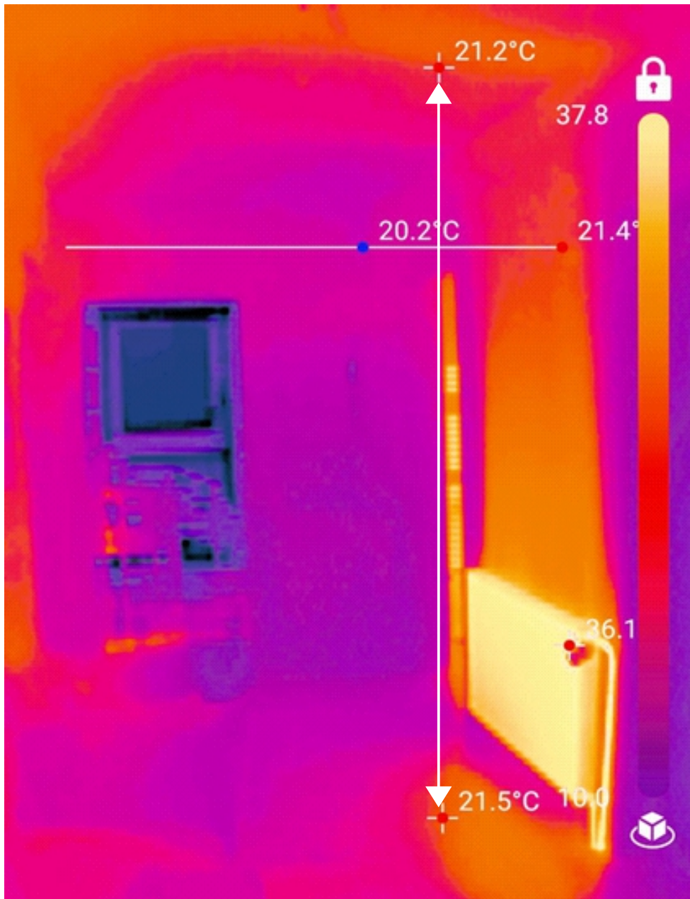
Gleichmäßige Wärmeverteilung auch bei Frost innerhalb eines Raumes mit Heizungsblut. Temperaturunterschied (Decke / Boden =0,3 °C) <= 1°C. 38°C Vorlauftemperatur.
